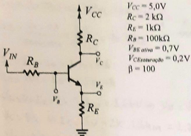
a) (0,25 ponto)  $V_{IN} = 0\text{V}$  Se  $V_{IN} \geq 0$ ,  $I_{BE} \approx I_{BC} \approx 0$ . Logo  $I_C = I_B = I_E = 0$
