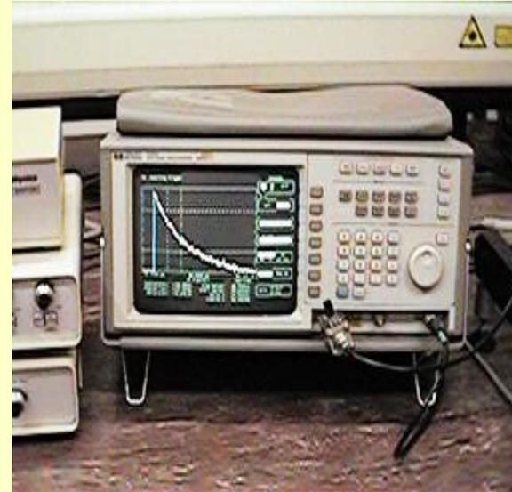
Decaimento de triplete do corante Safranine em solução micelar de SDS
