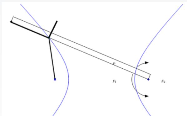
Para desenharmos um ramo de uma hipérbole, fixamos uma das extremidades de uma régua num dos focos, fixamos uma extremidade de um barbante, de comprimento igual ao comprimento da régua menos  $2a$ , na outra extremidade da régua e a outra extremidade do barbante no outro foco. Esticamos o barbante com uma caneta de forma que ela fique encostada na régua. Girando-se a régua em torno do foco no qual ela foi fixada, desenha-se um ramo da hipérbole.
