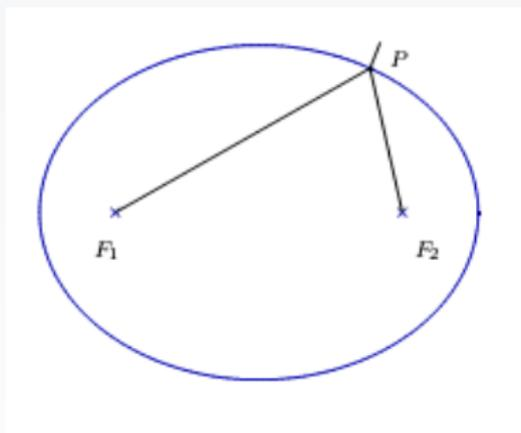
Podemos desenhar uma elipse se fixarmos as extremidades de um barbante de comprimento  $2a$  nos focos e esticarmos o barbante com uma caneta. Movimentando-se a caneta com o barbante esticado, desenha-se a elipse.
