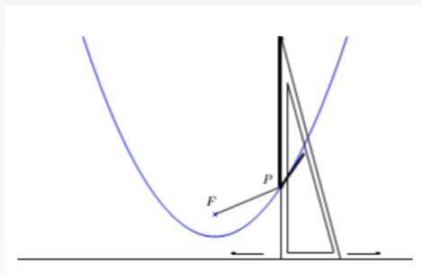
Colocamos um esquadro com um lado cateto encostado na reta diretriz, fixamos uma extremidade de um barbante, de comprimento igual ao lado cateto do esquadro perpendicular à reta diretriz, no foco, e a outra extremidade na ponta do esquadro oposta ao lado que está encostado na reta. Esticamos o barbante com uma caneta de forma que ela fique encostada no lado do esquadro perpendicular à reta diretriz. Deslizando-se o esquadro na reta diretriz, desenha-se uma parte da parábola.
