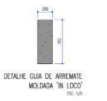
LEGENDA CONCRETO SARIJETAS/COM DE CONCRETO PRE-MOLDADO, ARREBITADO DE 20X20 (REF. PR 02/10) GUIA DE ARREBITADO DE CONCRETO PRE-MOLDADO 'IN LOCO' PARA DIFERENCIAÇÃO DE PISOS, LARGURA DE 10 CM (REF. PR 02/10) GUIA SIMPLES EM NÍVEL DE CONCRETO PRE-MOLDADO, LARGURA 10 CM (VER DETALHE PR 02/10) CONCRETO CANALAS/COM REBARBAS DE CONCRETO PRE-MOLDADO 'IN LOCO' (SARJETAS REF. PR 02/10) GUIA DE ARREBITADO DE CONCRETO PRE-MOLDADO 'IN LOCO' PARA DIFERENCIAÇÃO DE PISOS CONCRETO CANALAS/COM REBARBAS DE CONCRETO PRE-MOLDADO (SARJETAS REF. PR 02/10)
