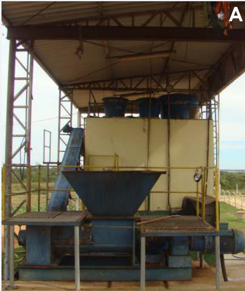
Figura 5. Triturador de carcaças de suínos mortos instalado em granja comercial de suínos (A). No detalhe, as lâminas que fazem a trituração do material (B).
