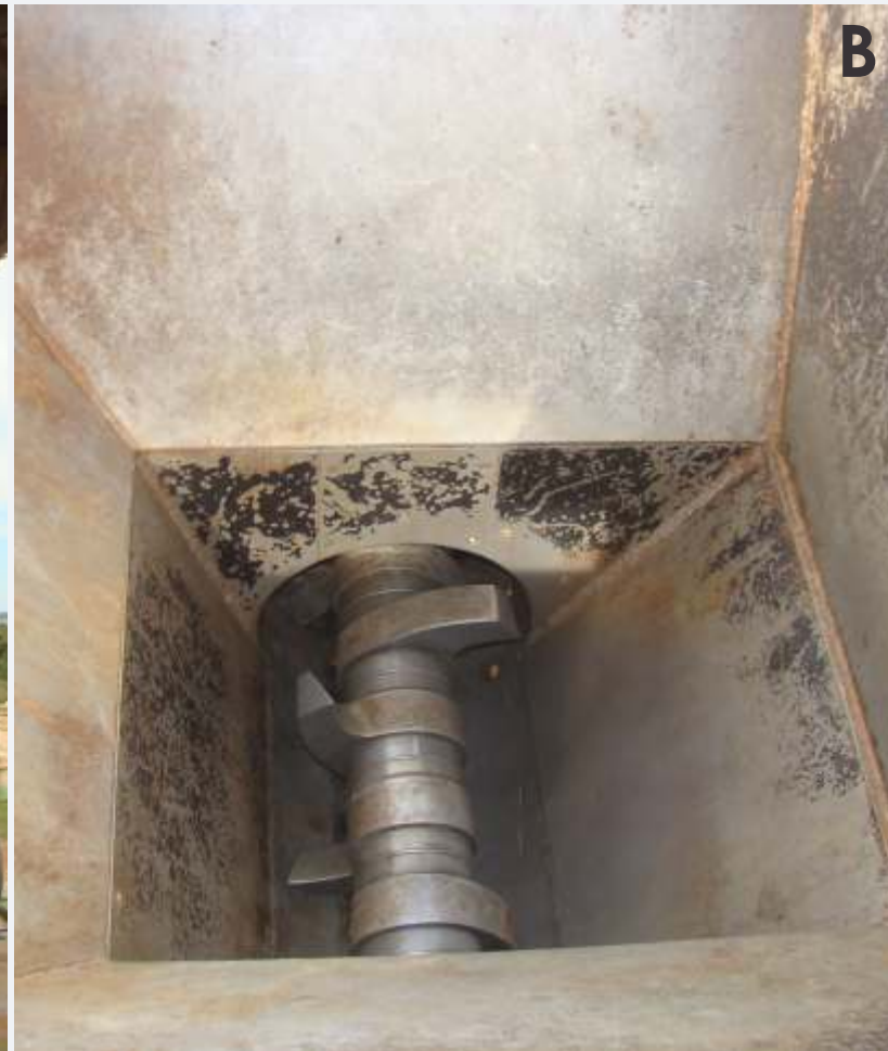
Figura 5. Triturador de carcaças de suínos mortos instalado em granja comercial de suínos (A). No detalhe, as lâminas que fazem a trituração do material (B).
