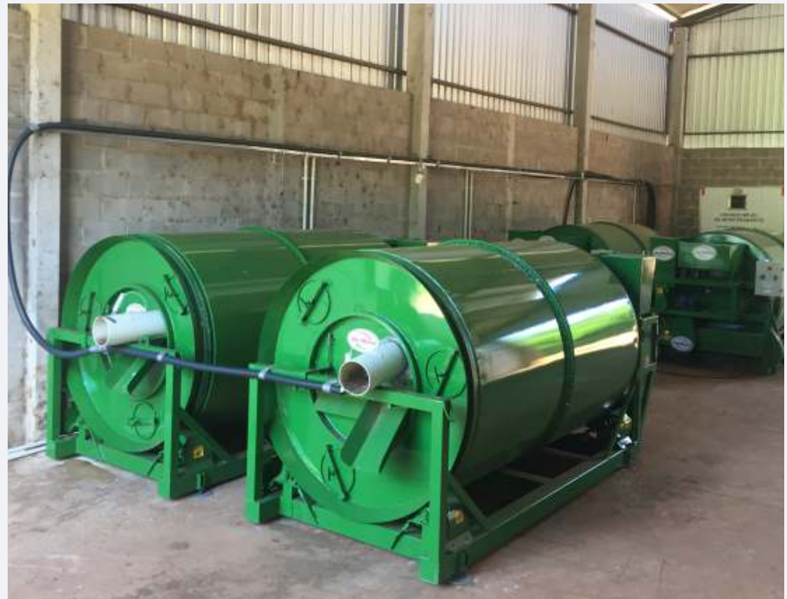
Figura 9. Reatores do tipo cilindro rotativo de 4 m 3 para compostagem acelerada de carcaças de animais mortos. Laboratório TEC-DAM, Embrapa Suínos e Aves, 2017.
