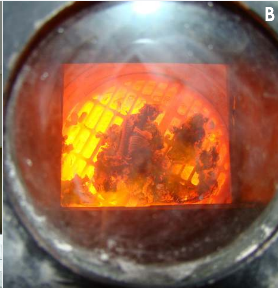
Figura 11. Incinerador de carcaças de suínos e aves e resíduos de alto risco sanitário (A). Carcaça durante processo de incineração com temperatura superior a 800°C (B). Laboratório TEC-DAM, Embrapa Suínos e Aves, 2017.
