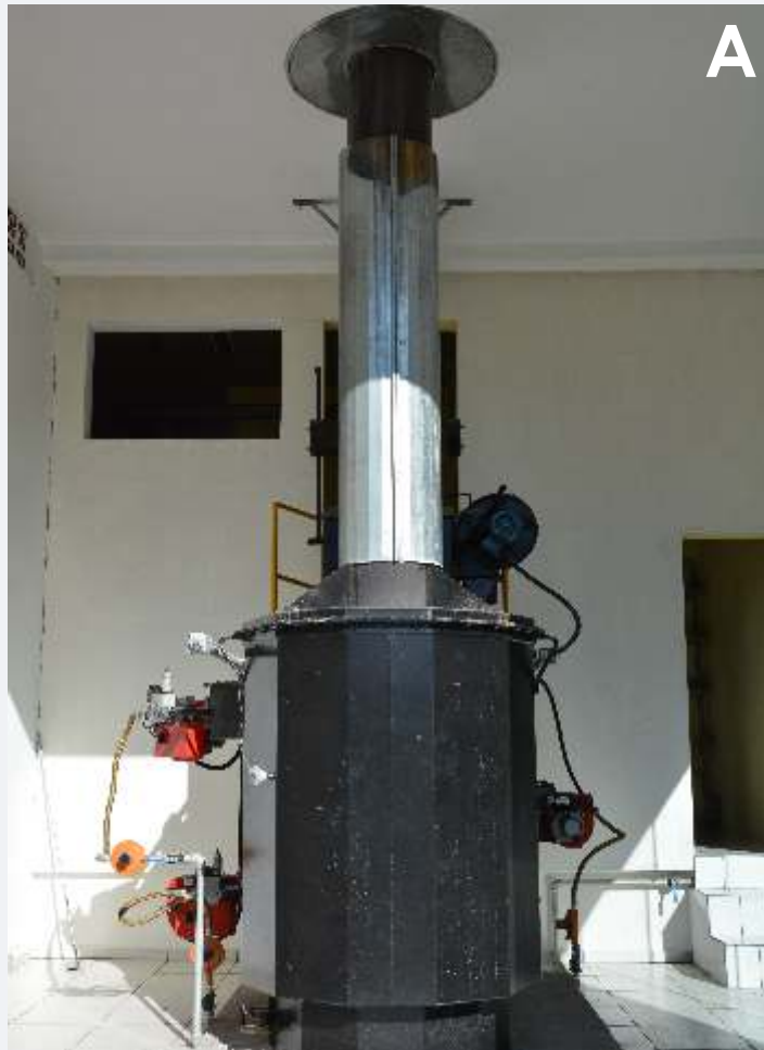
Figura 11. Incinerador de carcaças de suínos e aves e resíduos de alto risco sanitário (A). Carcaça durante processo de incineração com temperatura superior a 800°C (B). Laboratório TEC-DAM, Embrapa Suínos e Aves, 2017.
