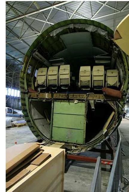
Fig. 2: Seções transversais (não circulares) de diversas aeronaves.
