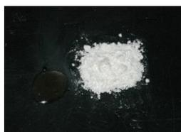
3. Dispensar uma gota do líquido próximo ao pó (conta-gotas perpendicular à placa). Para proporcionar o líquido corretamente, o conta-gotas não deve tremer: apoie a mão que segura o conta-gotas
