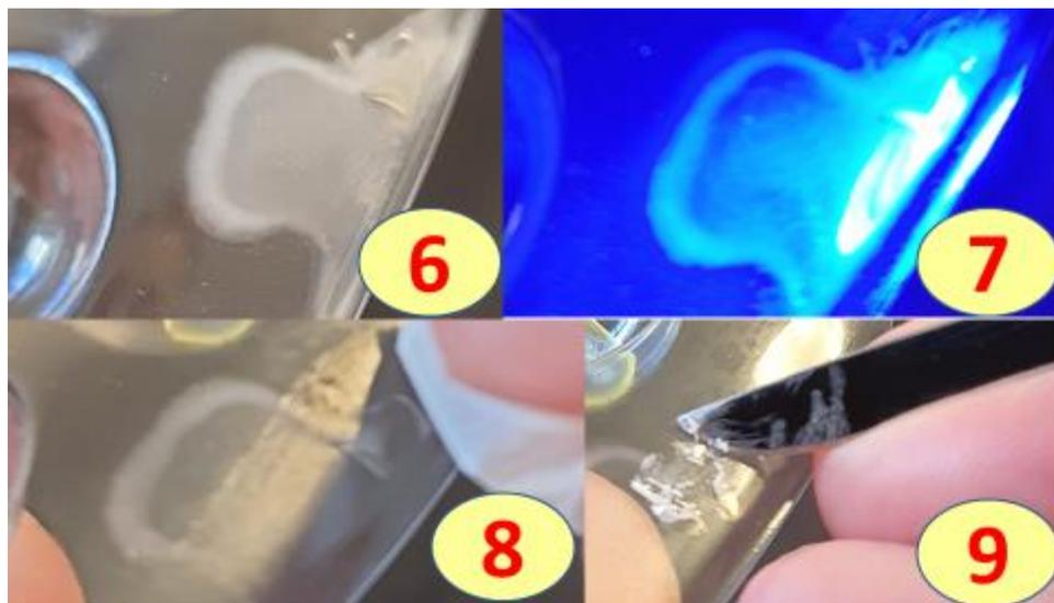
6. Repita o exercício usando o outro adesivo (Prime & Bond): pingue um gota na superfície externa do casulo; note que ele é bem mais fluido e se espalha rapidamente. Aguarde alguns segundos ate ele ganhar um aspecto opaco (devido à evaporação de solventes).
