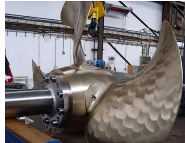
Figura 2. Eixo de um navio acoplado ao hélice [2].
