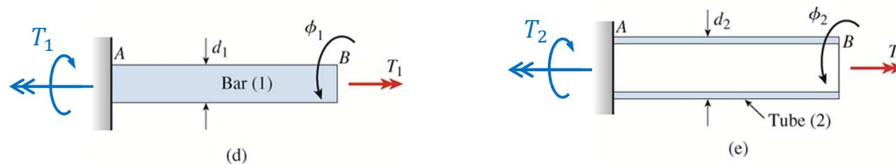
Cada uma destas estruturas, vistas separadamente, é uma estrutura isostática (veja os D.C.L.'s), e a determinação dos respectivos ângulos de giro é simples.
