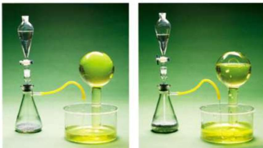
Figura 12-7 Aparelho para preparação de hidrogênio a partir de zinco e ácido sulfúrico.
