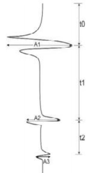
Figura 2. Exemplo do traço de GPR para o modelo ao lado.
