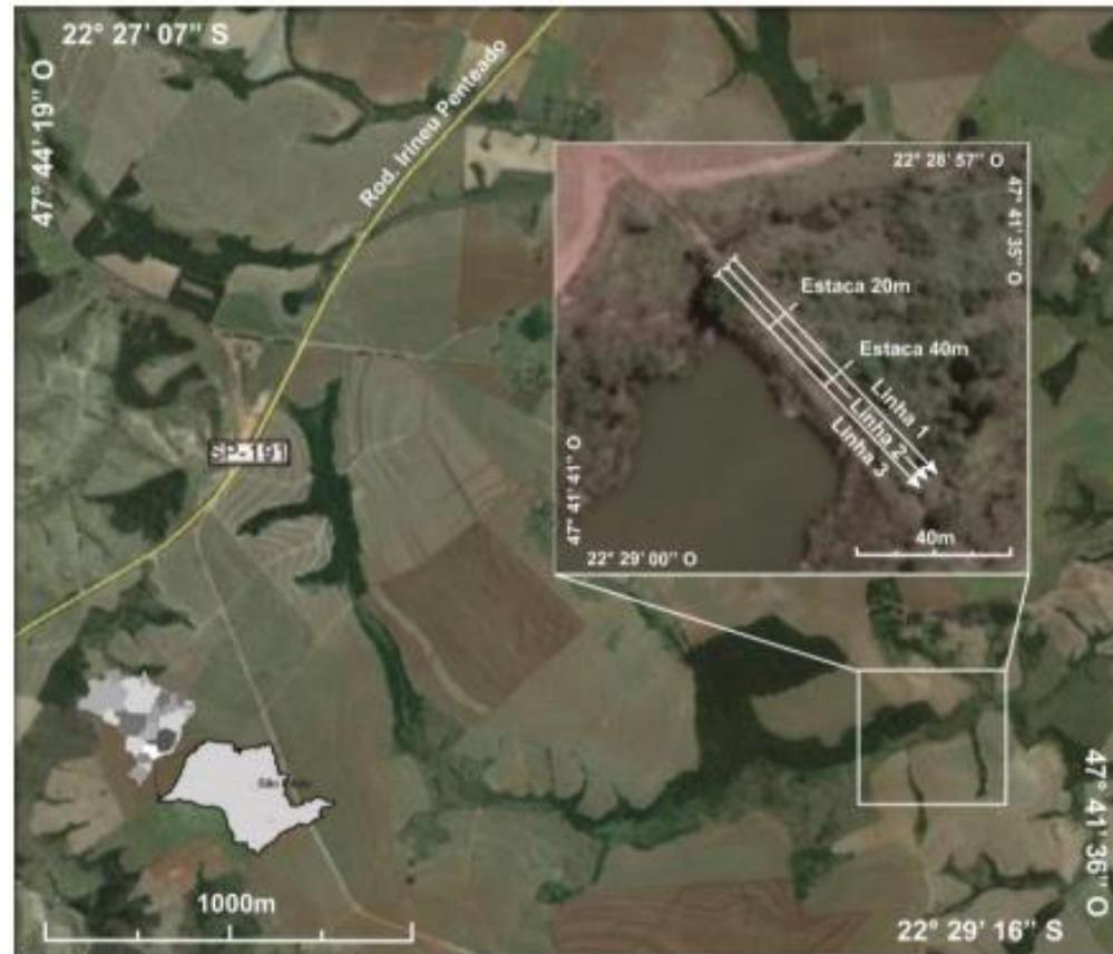
**Figura 6.2:** Linhas de imageamento elétrico 1, 2 e 3 – Cordeirópolis.
