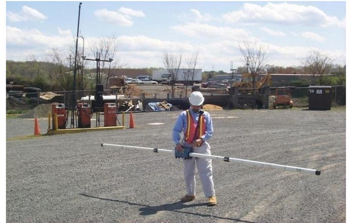
Figura 12 - sistema de GPR com antenas blindadas de 80 MHz.
