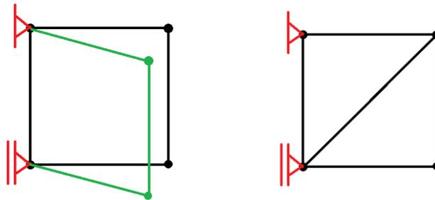
Figura 1. Estrutura plana deslocável e treliça plana indeslocável
