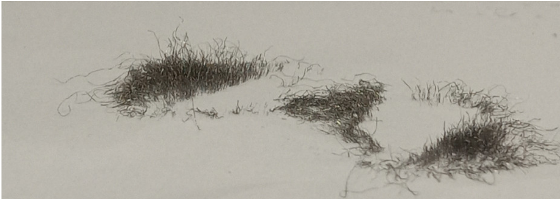
Figura 1: Papel sulfite com um “forte” ímã abaixo dele e limalha de ferro depositada sobre ele. Este arranjo é feito para identificar a direção do campo magnético do ímã.
