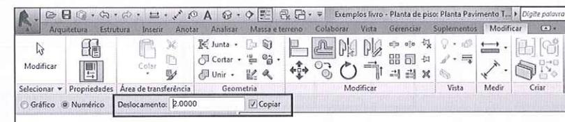
Figura 6.4 – Aba Modificar | Paredes, comando Deslocamento.
