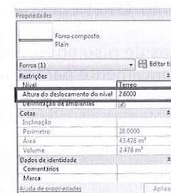
Figura 9.72 – Definição da altura do forro.
