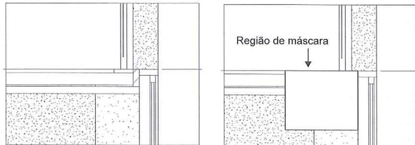
Figura 15.131 – Exemplo de Região de máscara cobrindo parte do detalhe.
