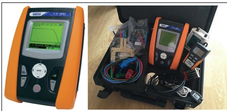
Figura 3.1 - Equipamento SOLAR I-Vw utilizado para obtenção de curvas IxV. Fonte: HT Instruments , 2016.
