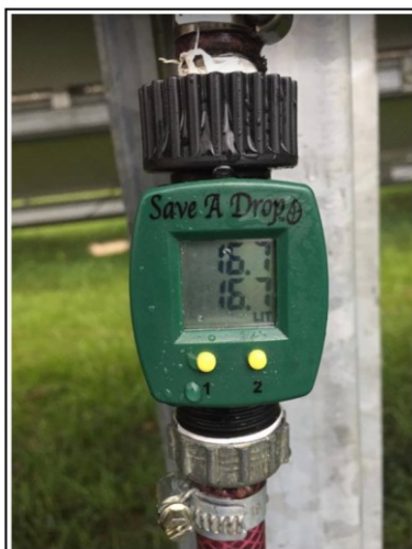
Figura 4.10 - Consumo de água da segunda limpeza da mesa 7, registrado no medidor de vazão. Fonte: Acervo do Autor, 2017.
