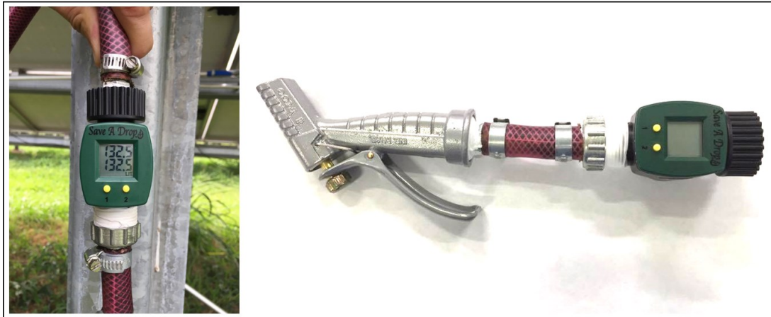
Figura 3.3 - Medidor de vazão e materiais do conjunto. Fonte: Acervo do Autor, 2016.
