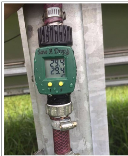
Figura 4.2 - Consumo de água da primeira limpeza da mesa 7, registrado no medidor de vazão. Fonte: Acervo do Autor, 2017.
