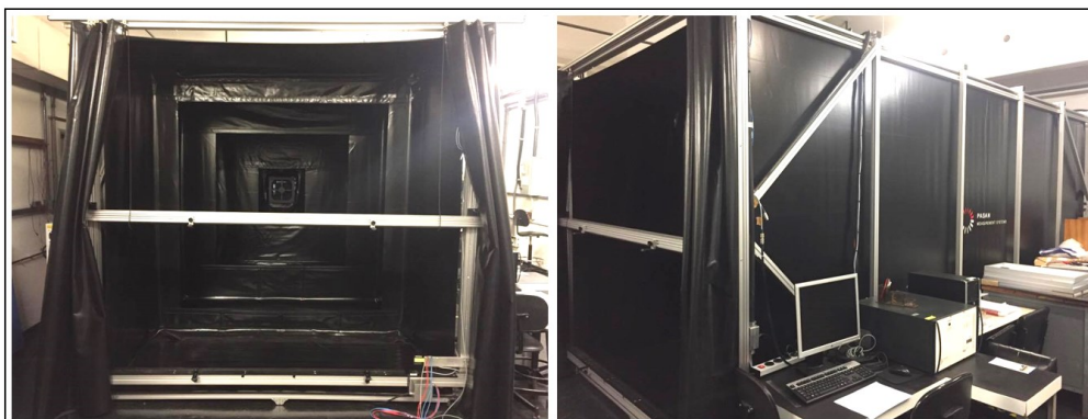
Figura 3.2 - Simulador HighLIGHT tester LMT utilizado para obtenção de curvas IxV de módulos sujos e limpos. Fonte: Acervo do Autor, 2016.
