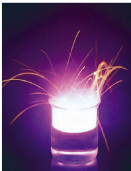
Figura 4-4. Potássio, como outros metais do Grupo IA, reage vigorosamente com a água. Para esta fotografia, ao recinto estava completamente escuro e toda a luz que você vê aqui foi produzida soltando um pequeno pedaço de potássio em um copo de água.
