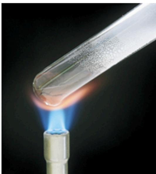
Óxido de mercúrio (II), um composto vermelho, se decompõe, quando aquecido, nos dois elementos: mercúrio (um metal) e oxigênio (um não-metal). O vapor de mercúrio condensa na parte superior mais fria do tubo de ensaio.
