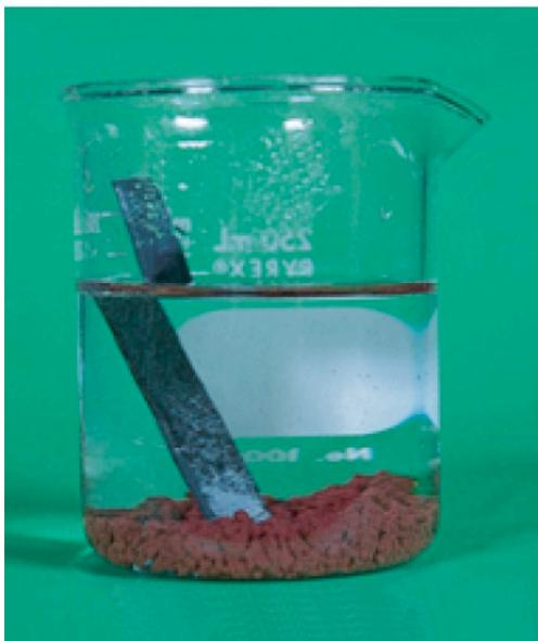
Uma tira de zinco metálico foi colocada em uma solução azul de sulfato de cobre (II),  $\text{CuSO}_4$ . O cobre foi deslocado da solução e tem caído no fundo do béquer. O sulfato de zinco resultante,  $\text{ZnSO}_4$ , solução é incolor.
