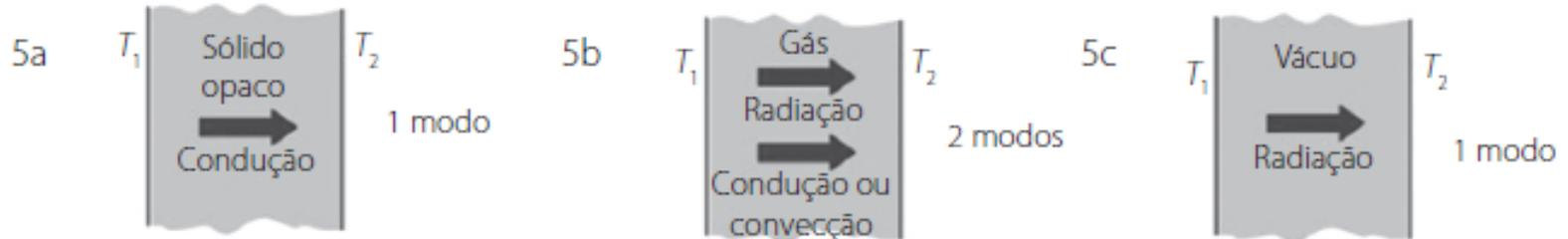
**Figura 5.** Representação de três situações envolvendo transferência de calor.
