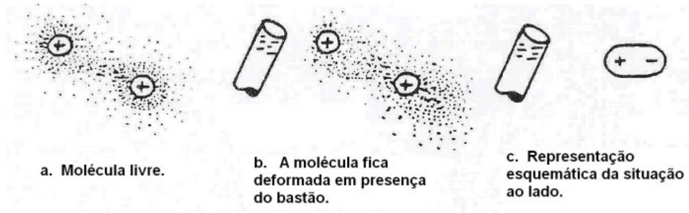
Figura 4.3: Polarização de moléculas.
