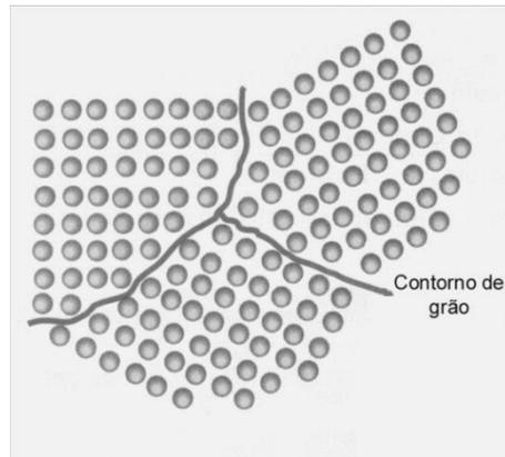
Figura esquemática mostrando os contornos de grão [6].
