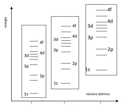
Figura 1.4 – Energias dos orbitais atômicos. Representação esquemática das energias dos orbitais dos níveis 1, 2, 3 e 4 para três elementos consecutivos na Tabela Periódica. Observe-se que a energia de um dado tipo de orbital cresce com Z. Observe-se também que, para cada elemento, a energia do orbital 4s é menor que a do 3d.
