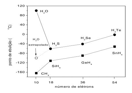
Figura 1.59 – Efeito da ponte de hidrogênio sobre o ponto de ebulição da água
