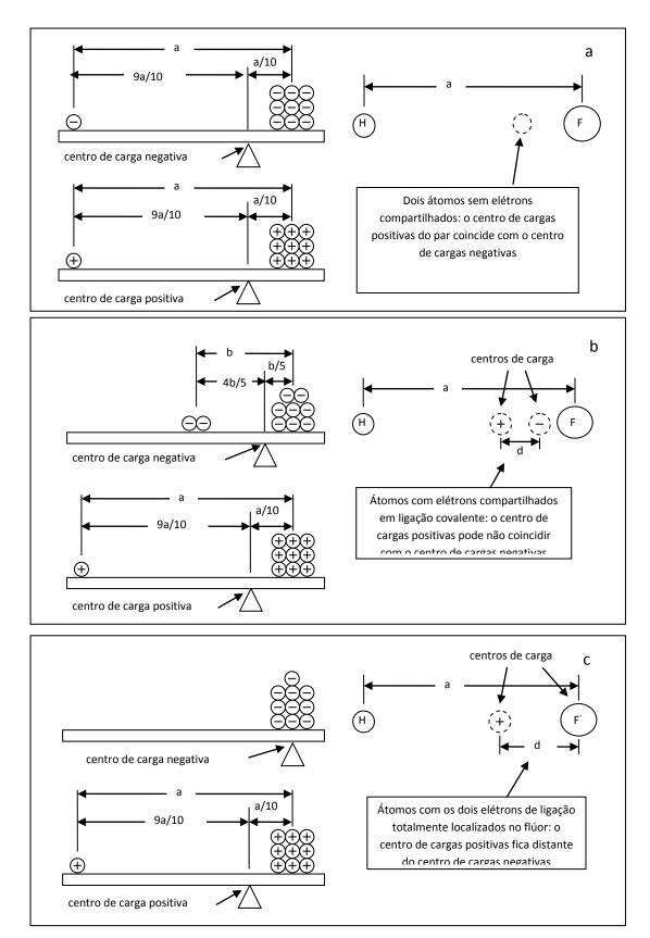
**Figura 1.28** – Posição dos centros de carga elétrica para átomos em três situações: a)sem elétrons compartilhados; b) elétrons compartilhados; c) com caráter totalmente iônico. ). Pode-se calcular o momento tanto considerando-se todas as cargas e a distância *d*, como considerando apenas uma carga e a distância *a*. (Desenhos fora de escala)
