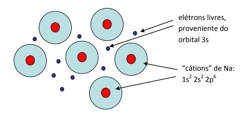
Figura 1.29 – Modelo simples da ligação metálica: cátions e elétrons livres
