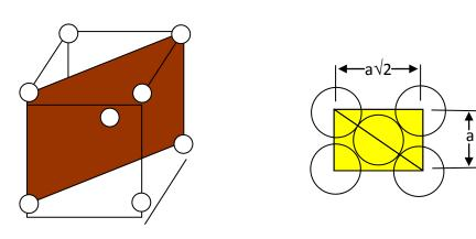
Figura 1.39 – Plano diagonal (no qual os átomos se tocam) no CCC
