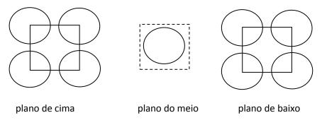
Figura 1.38 – Célula unitária do sistema cúbico de face centrada
