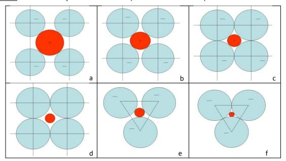
**Figura 1.44** – Ilustração esquemática dos possíveis arranjos espaciais de ânions e cátions. Quando ânions "encostam" uns nos outros, a estrutura é impossível (casos "c", "d" e "f").
