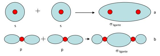
Figura 1.12 – Orbitais ligantes do tipo  $\sigma$ : a) a partir de s + s; b) a partir de p + p. Forma-se  $\sigma$  também a partir de s + p.
