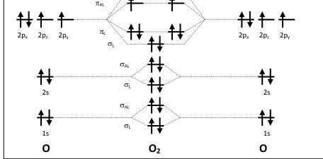
**Figura 1.18** – Níveis energéticos dos orbitais moleculares de de  $N_2$  (em cima) e de  $O_2$  (em baixo). Observe-se que no  $N_2$  a energia do orbital  $\sigma$  é superior à dos orbitais  $\pi$ , e no  $O_2$  ocorre o inverso, para os orbitais ligantes.
