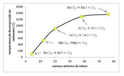
Figura 1.49 – Temperatura de decomposição de carbonatos em função do número atômico de seus cátions
