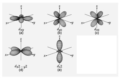
Figura 1.7 - Orbitais do tipo d. Regiões com 95% de probabilidade de se encontrar o elétron.
