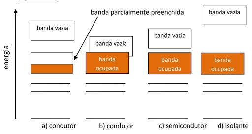
Figura 1.17 – As bandas eletrônicas e a condutividade elétrica
