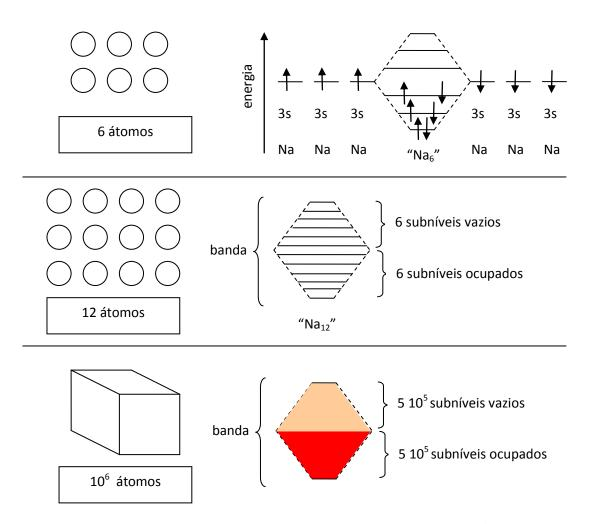
**Figura 1.16** – Visão esquemática da formação de uma banda 3s, em um cristal de Na com 10<sup>6</sup> átomos. As etapas com 6 e 12 átomos são irrealistas e têm objetivo puramente didático. A distribuição de energias da banda final é simplificada: em cristais reais ela pode não ser simétrica em relação à energia do orbital 3s.
