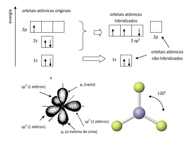
**Figura 1.24** – Hibridização sp<sup>2</sup> do boro. a) Boro hibridizado. b) BF<sub>3</sub> ou BCl<sub>3</sub>, com ligações  $\sigma$  entre os orbitais hibridizados do boro e orbitais p do flúor ou do cloro.
