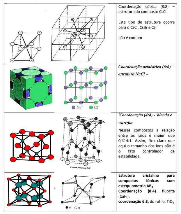
Figura 1.46 – Estruturas cristalinas típicas para diversas relações de coordenação
