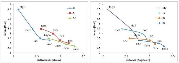
**Figura 1.47** – Variação da dureza na Escala de Moh com a distância MX (cátion-ânion) para alguns cristais com estrutura NaCl e cargas +1 e -1
