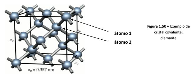
Para ficar mais claro, apresentamos na <u>Figura 1.51</u> os três planos superiores do cubo da Figura 1.50, e indicamos o par de átomos considerado. O átomo 1 evidentemente obedece à simetria CFC. O átomo 2 também obedece: para verificar, basta desenhar o seu plano de maneira mais completa, o que é feito na Figura 1.51-b. Pode-se observar que este plano é semelhante ao do topo (e também ao de meia altura) e que, portanto, estes átomos de C seguem a simetria CFC.
