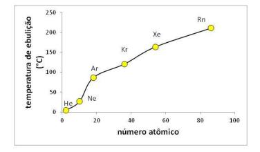
Figura 1.57 – Temperatura de ebulição de gases nobres em função de seu número atômico
