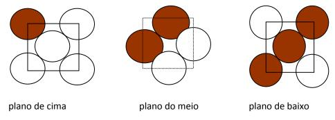
Figura 1.34 – Célula unitária do sistema cúbico de face centrada
