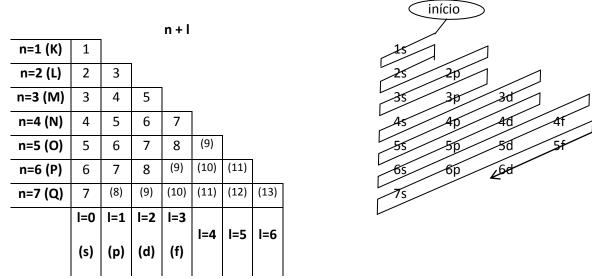
**Figura 1.8** – Sequência de preenchimento dos orbitais (Obs.: Os valores de n+l que foram colocados entre parêntesis correspondem a subcamadas teòricamente possíveis, mas que, em virtude de só se conhecerem 106 elementos na Tabela Periódica, não chegam a existir. Assim, a subcamada mais energética que efetivamente se conhece no estado fundamental é a 6d.)
