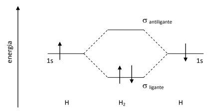
**Figura 1.15** – Energia de orbitais atômicos 1s em átomos de hidrogênio e dos orbitais moleculares σ resultantes (ligante e antiligante)
