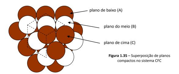
Se, na Figura 1.35, selecionarmos átomos adequados, podemos ver uma célula unitária CFC. Tirando alguns átomos do caminho, temos a <u>Figura 1.36</u>. Observem que o desenho mostra 14 átomos (8 nos vértices e 6 nas faces). Entretanto, a célula unitária só contém 4 átomos, pois só 1/8 de cada átomo de vértice e só ½ de cada átomo de face está dentro da célula:
