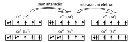
Figura 1.9 - Orbitais "d" externos de íons de metais de transição.
