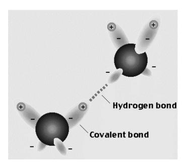
Figura 1.58 – Pontes de hidrogênio entre duas moléculas de água. O sinal "-" indica simplesmente que a nuvem é de elétrons, e não o número de elétrons.
