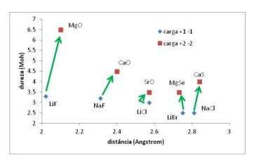
Figura 1.48 – Variação da dureza com a carga iônica em alguns cristais com estrutura NaCl
