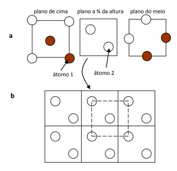
Figura 1.51 – Planos da estrutura do diamante. a) os três planos superiores (os átomos escuros são os quatro vizinhos próximos do átomo 2); b) visualização mais ampla do plano a ¾ da altura, com seis cubos.
