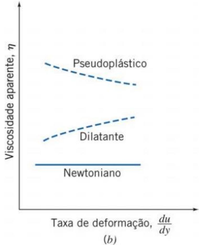
(a) Tensão de cisalhamento,  $\tau$ , (b) viscosidade aparente,  $\eta$ , como uma função da taxa de deformação para o escoamento unidimensional de vários fluidos não newtonianos.
