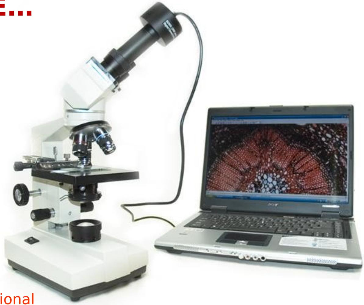
Microscopia óptica convencional com um sistema de captura de imagens digital acoplado à um computador
