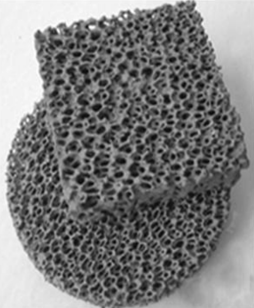
Espuma cerâmica com célula fechada: isolamento térmico (~ 1800°C)
