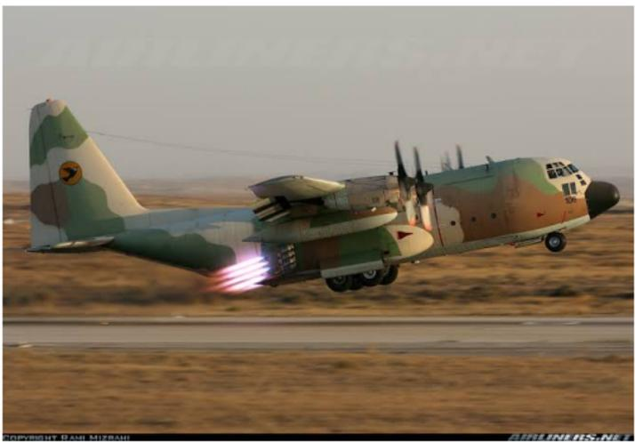
Figura: C130 Equipado com Foguetes
