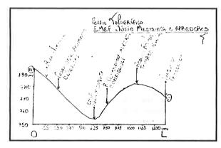
Observe na planta abaixo o Ponto A e o Ponto B verificados no Perfil. Ligue estes dois pontos com uma régua (linha reta entre os pontos A e B). A linha revelará para você o local representado no perfil topográfico.
