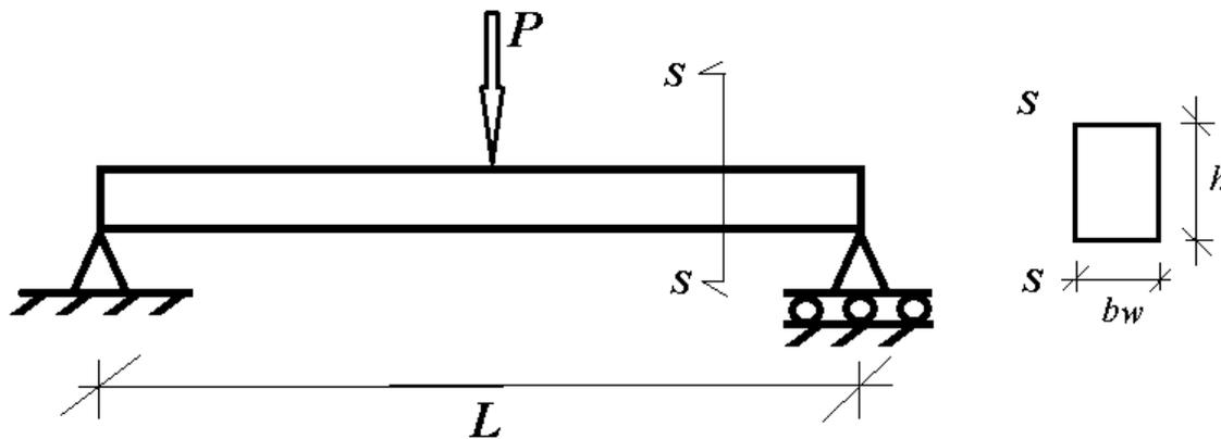
Figura 3.4 – Viga bi-apoiada submetida a carga concentrada
