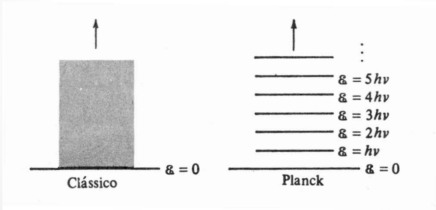
*A diferença de energia quantizada dos osciladores entre o estado  $n$  e o estado  $n+1$ , para qualquer frequência*
