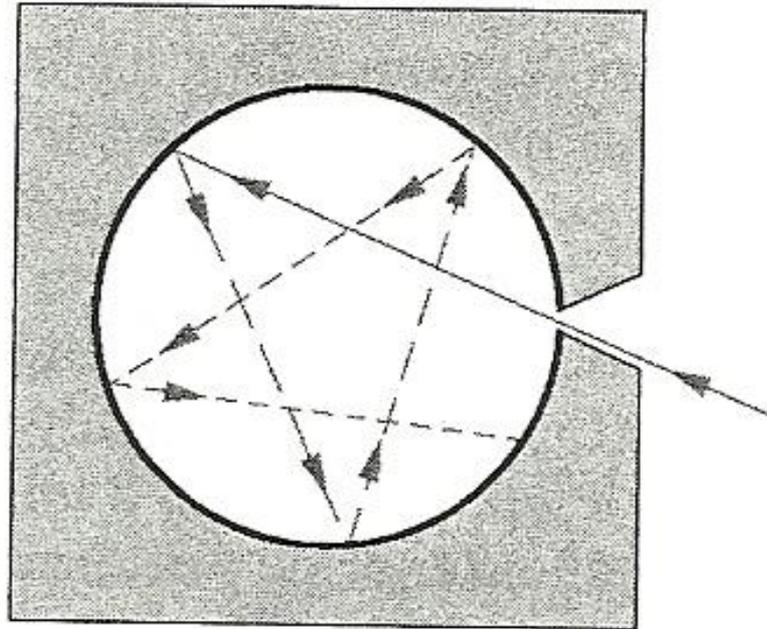
**Fig. 3-8** Uma cavidade com um pequeno furo se comporta como um buraco negro ideal. A probabilidade de que um raio que entra na cavidade torne a sair pelo furo antes de ser absorvido pelas paredes é extremamente pequena.
