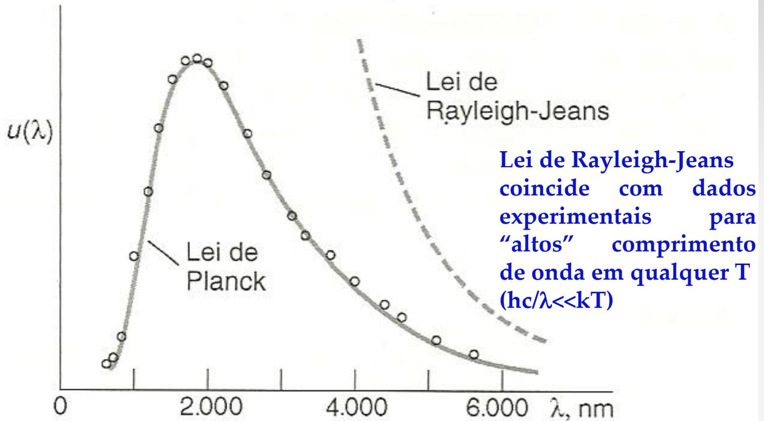
**Fig. 3-9** Comparação da lei de Planck e da lei de Rayleigh-Jeans com os resultados experimentais obtidos por W. W. Coblentz, por volta de 1915, para um buraco negro a  $T = 1.600 \text{ K}$ . A escala do eixo vertical é linear. [Adaptado de F. K. Richtmyer, E. H. Kennard e J. N. Cooper, *Introduction to Modern Physics*, 6th ed., McGraw-Hill Book Company, New York, 1969, com permissão.]
