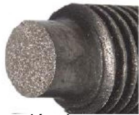
Fratura frágil ocorre sem qualquer deformação apreciável e formação de trincas
