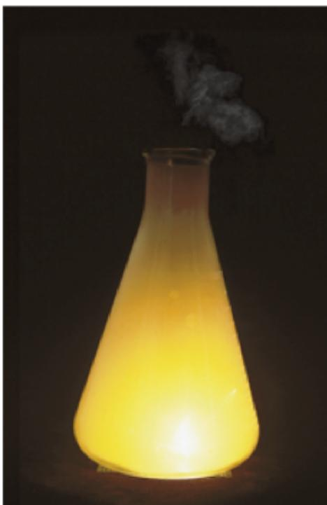
**Figura 1-10** A reação do sódio, um elemento sólido e cloro, um elemento gasoso, para produzir cloreto de sódio (sal de cozinha). Esta reação libera energia considerável na forma de calor e luz.
