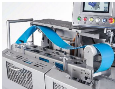
Limpeza higiênica da cinta transportadora no local
