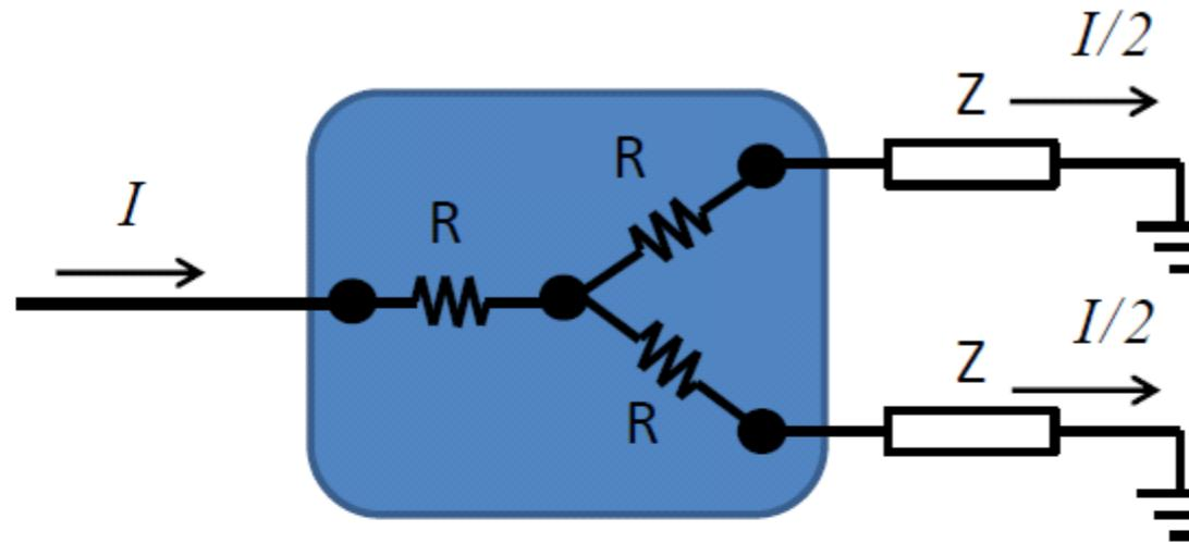
Conexão com divisor resistivo simétrico
