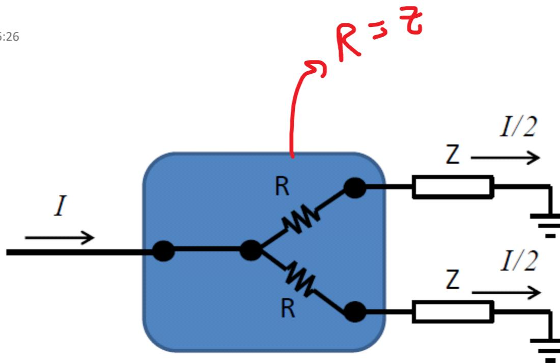
Conexão com divisor resistivo
