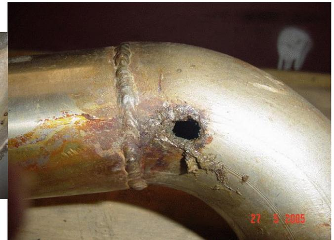
Corrosão em fresta próximo à solda em aço inox 304
