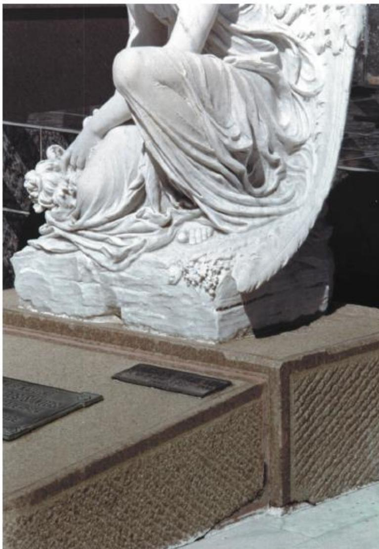
**Fig. 8.15** Rochas diferentes expostas na mesma época (década de 1960), apresentando diferentes graus de alteração. A escultura, em mármore, encontra-se bastante alterada, enquanto o túmulo, em granito, está bem melhor preservado. Foto: M. C. M. de Toledo.
