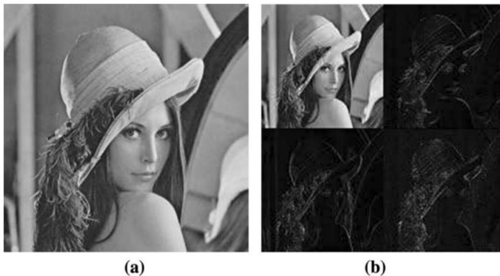
Figura 3: a) Imagem original, b) Imagem gerada pela wavelet usando um nível de decomposição
