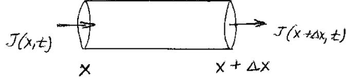
Figure 1: Fluxo de calor através de um cilindro elementar com as paredes laterais isoladas e o eixo ao longo da direção  $x$ .
