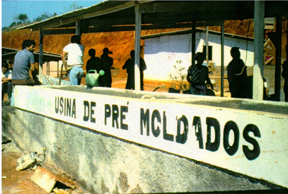
*Figura 33 Vista do tanque de cura para peças de argamassa armada*
