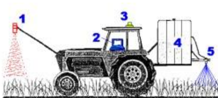
Figura. Princípio de funcionamento de um sistema de aplicação localizada de herbicidas em tempo real: 1) Sensor de alvos biológicos (ex. plantas daninhas); 2) Computador de bordo (controle do sistema de pulverização); 3) Receptor GPS (conectado ao radar de velocidade); 4) Reservatório de água e agroquímicos; 5) Sistema de pulverização (injeção direta de agroquímicos).
