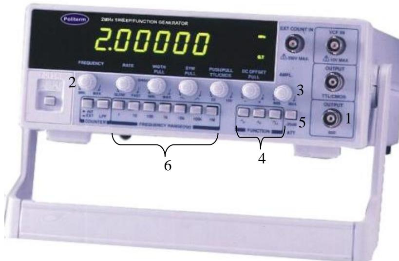
Figura 2: Painel do gerador de função Politem FG-8102
