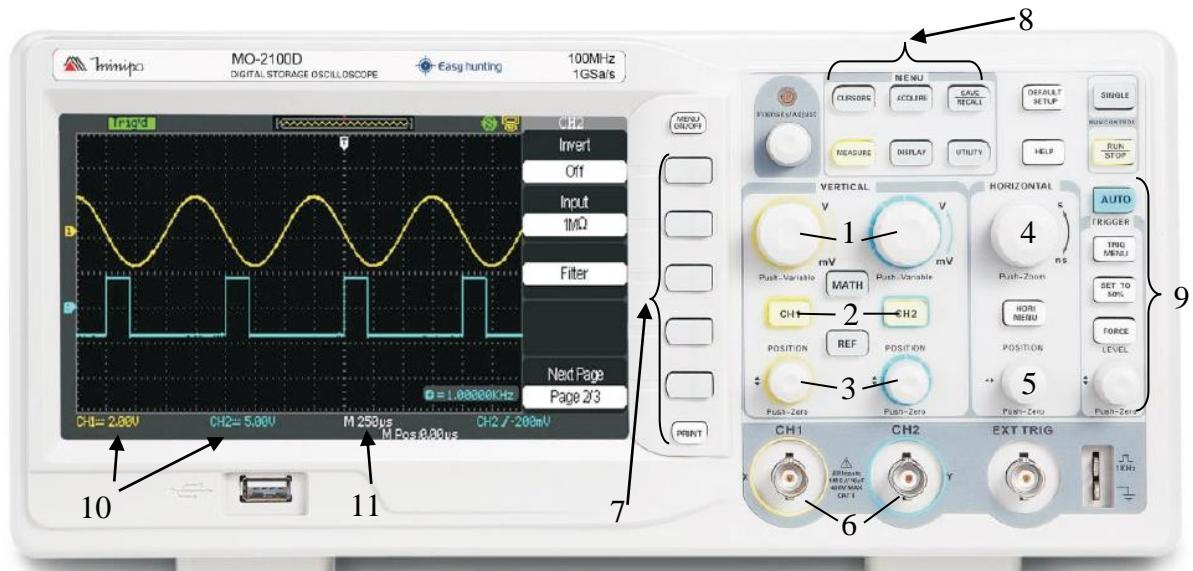
**Figura 1: Painel do osciloscópio digital Minipa MO-2100D**
