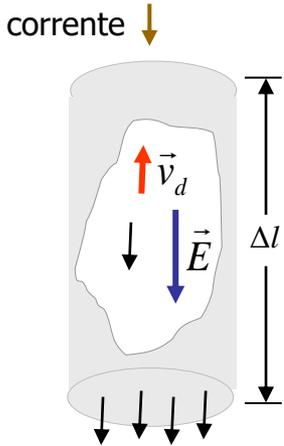
Na figura ao lado representamos um trecho de um fio condutor de tamanho  $\Delta l$ , com um corte para visualizar o que está ocorrendo em seu interior.
