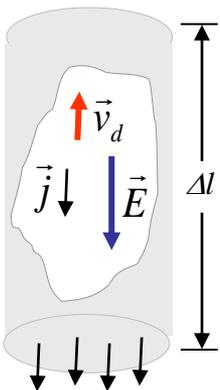
Na figura ao lado representamos um trecho de um fio condutor de tamanho  $\Delta l$ , com um corte para visualizar o que está ocorrendo em seu interior.
