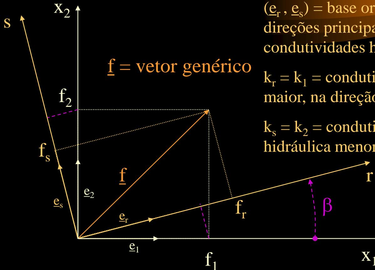
$(\underline{e}_r, \underline{e}_s)$  = base orientada segundo direções principais de condutividades hidráulicas
