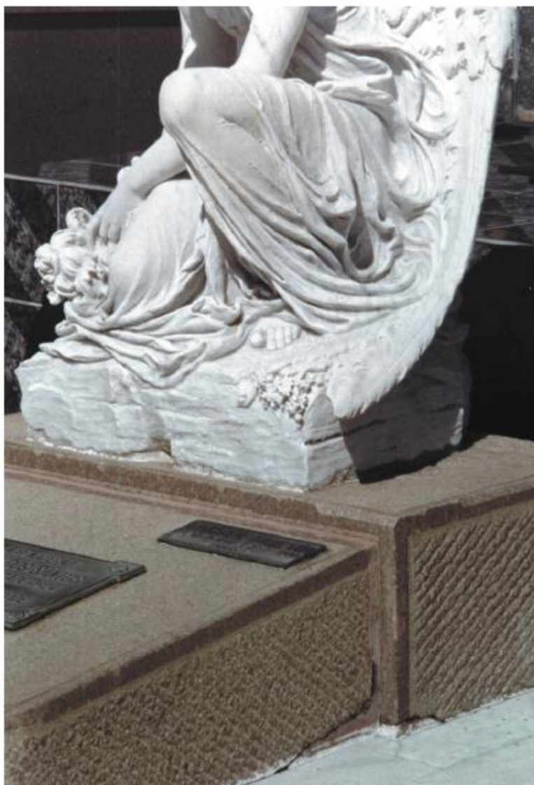
Fig. 8.15 Rochas diferentes expostas na mesma época (década de 1960), apresentando diferentes graus de alteração. A escultura, em mármore, encontra-se bastante alterada, enquanto o túmulo, em granito, está bem melhor preservado. Foto: M. C. M. de Toledo.
