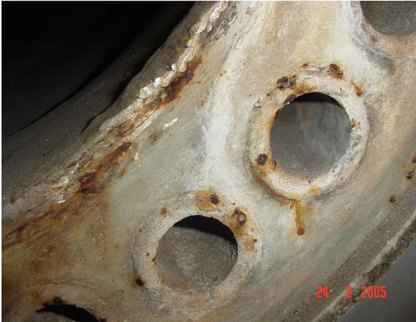
Corrosão por pites e em frestas -aço inox 304 – região de falha na solda do trocador de calor
