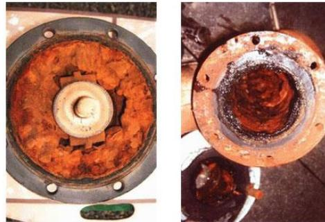
Válvula que parou de funcionar pelo seu bloqueio por produtos de corrosão
