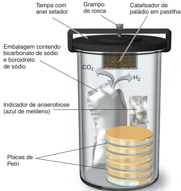
Figura 6.6 Uma jarra para cultivar bactérias anaeróbicas em placas de Petri. Quando água é adicionada à embalagem química contendo bicarbonato de sódio e boroidreto de sódio, hidrogênio e dióxido de carbono são gerados. O catalisador de paládio está localizado em uma câmara separada, que também pode ser incorporada na embalagem química, e na sua superfície ocorrerá a reação entre o hidrogênio e o oxigênio do interior da jarra, que combinados formarão água. O oxigênio é assim removido. Na jarra há também um indicador de anaerobiose contendo azul de metileno, que tem a coloração azul quando oxidado, tornando-se incolor quando o oxigênio é removido (como mostrado aqui).
