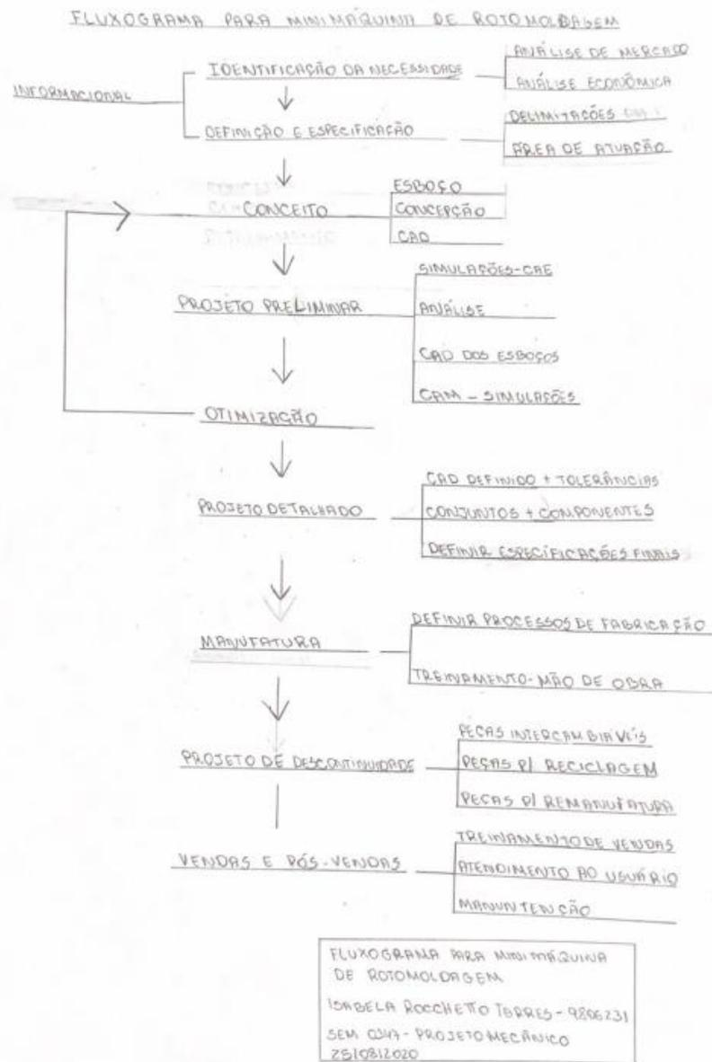
**Metodologia de Projeto de uma mini-máquina de Rotomoldagem**
