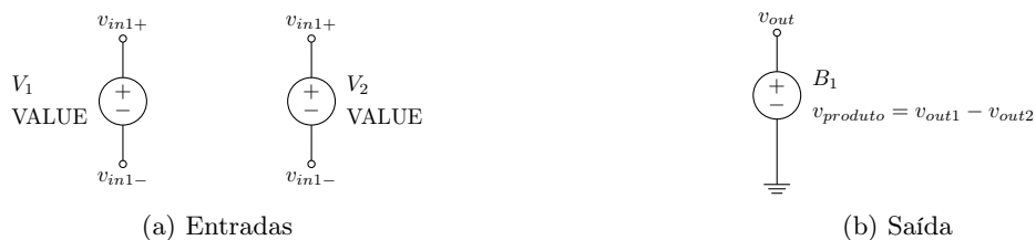
Figura 3: Multiplicador Analógico - subcircuitos de entrada e saída
