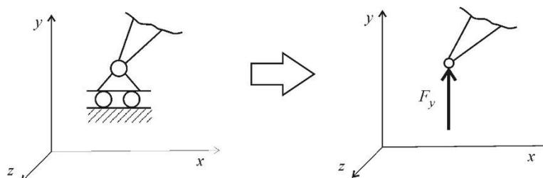
Observação: este apoio (bilateral) impede também que o ponto se “descole” do plano; existe o “apoio simples unilateral” que não tem esse efeito, ou seja, fornece reação de apenas um sentido, e tem a mesma representação gráfica que o bilateral. Assim, quando o apoio for unilateral, isso
