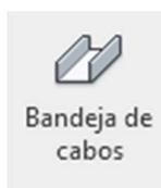
Ao ativar este ícone, podemos escolher uma série de bandejas que foram carregadas anteriormente no REVIT, mas para poder usá-las, precisamos de seus acessórios: uniões, curvas, dobras, Ts, cruzamentos e reduções; fizemos isso carregando a família anteriormente do arquivo “Bandeja de cabo > Conexões” na biblioteca REVIT. Uma vez carregado, precisamos "editar o tipo" nas propriedades da bandeja e, ao fazê-lo, exibe a seguinte tabela:
