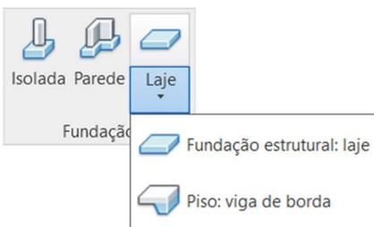
Tendo o desenho importado, vamos para a guia "Estrutura" e depois para o grupo "Fundação", onde encontramos três opções para executar a base do projeto.
