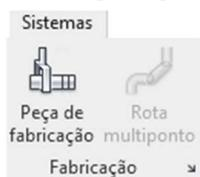
Antes de trabalhar com tubos, é bom abrir a caixa de diálogo "Configuração de fabricação", que é aberta no painel de sistema, grupo "Fabricação", clicando na seta inferior esquerda, que exibe a tabela a seguir:
