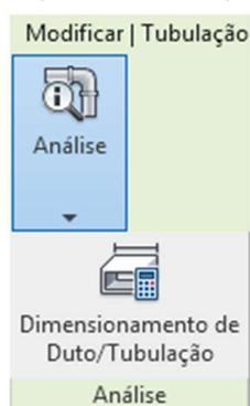
Dessa forma, podemos revisar a seção com a ferramenta "Alterar tamanho", que é ativada quando o parâmetro "Fluxo" é ativado. O programa sugere o diâmetro que calcula de acordo com o fluxo.
