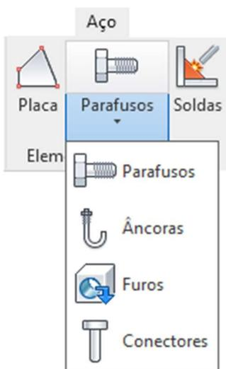
Uma nova ferramenta que o REVIT 2020 nos oferece é a guia Steel, que, ao clicar nela, também mostra os grupos "Elementos de fabricação", "Modificadores" e "Cortes paramétricos".
