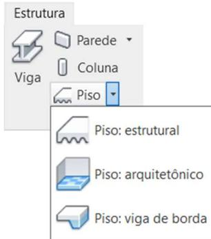
Depois de desenhar as vigas no nível correspondente, começaremos com o desenho da laje.
