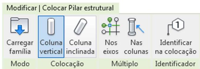
Como podemos ver na borda verde que se desdobra para poder editar o pilar, também encontramos a maneira de localizar o pilar dentro do desenho: "Nos eixos" ou "Nas colunas", "Inclinada" ou "Vertical" e a maneira de rotulá-lo no desenho e
