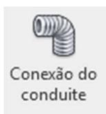
Da mesma forma que bandejas e tubos de encanamento na parte elétrica, também podemos colocar individualmente a "Conexão de conduíte", em cotovelo, T, união, cruz ou transição.
