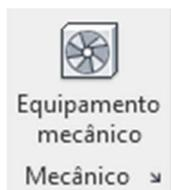
Antes de gerar um projeto e conectar os dutos ao sistema, é importante adicionar o "Equipamento Mecânico" ao sistema. Fazemos isso procurando o equipamento ideal na guia "Sistemas" no grupo "Mecânico".
