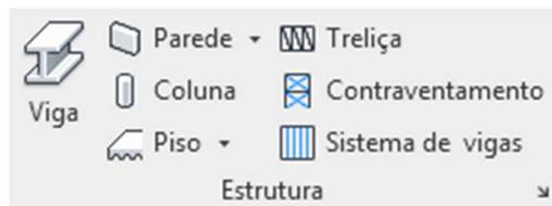
Além dos ícones que usamos na arquitetura, como "Parede", "Coluna" e "Piso", encontramos o ícone "Viga", que nos oferece as diferentes vigas de concreto ou de estrutura metálica para colocar em nosso desenhando.
