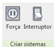
Antes de criar os fios, devemos conectar a iluminação aos interruptores, para isso indicamos a iluminação que queremos controlar e, nesse momento, a barra de edição mostra o ícone "Interruptor", no painel "Criar sistema". Clicamos neste ícone e abrimos um painel "Ferramentas do sistema", com o ícone "Selecionar opção"; apontamos para o interruptor na vista e o luminar está conectado.
