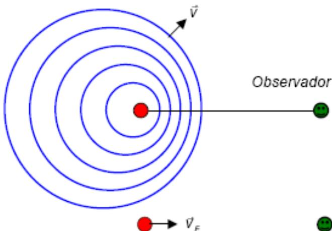
depreender pela figura ao lado. Se em um tempo  $T$  (período) uma frente de onda viajou uma distância  $\lambda = v T$  (comprimento de onda original), como a fonte se aproximou do observador de  $v_F T$ , o observador perceberá um comprimento de onda  $\lambda'$  diferente do original:
