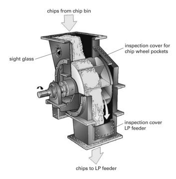
Figure 6.10. Chip meter (Kvaerner Pulping).
