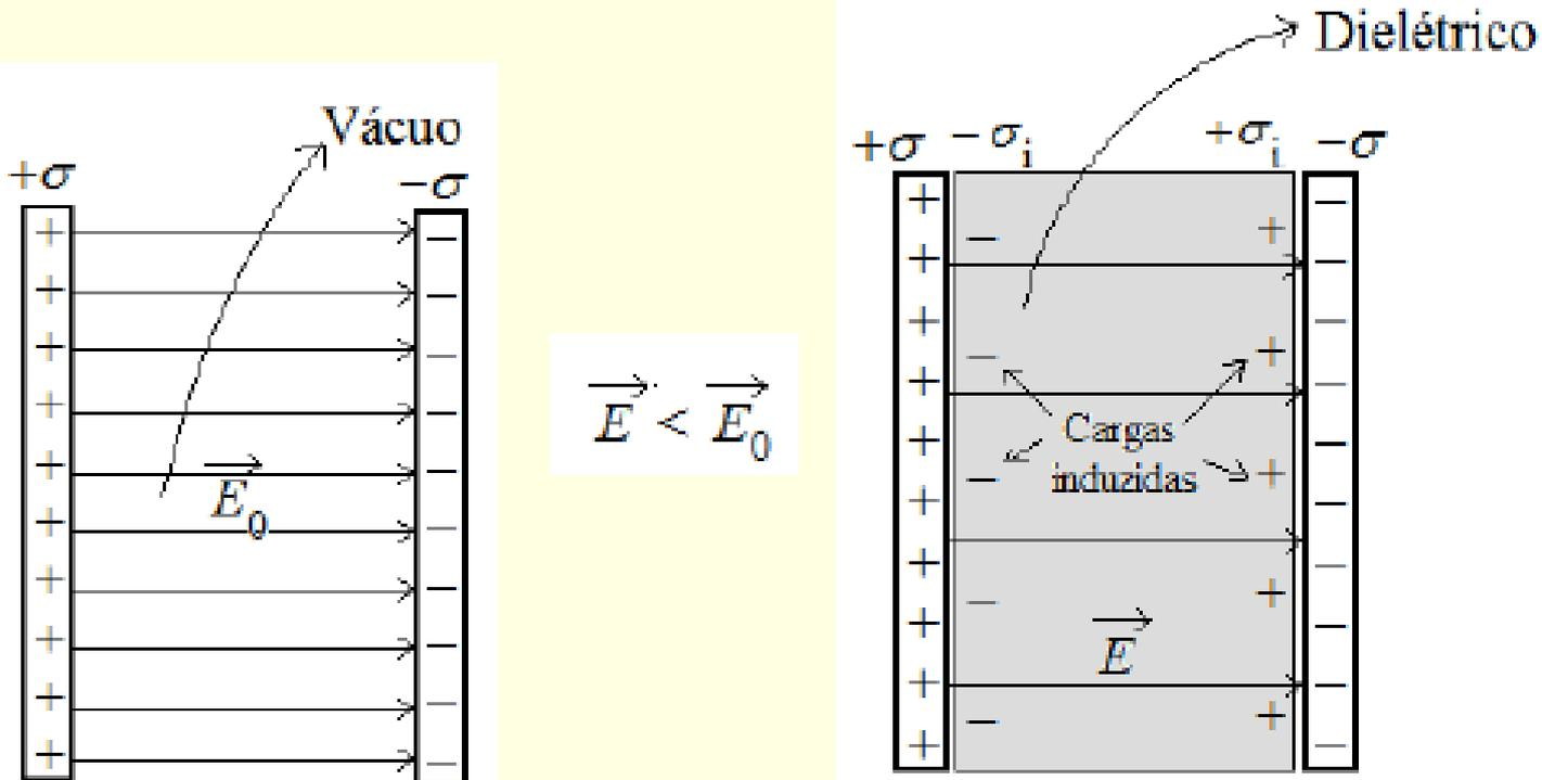
A densidade de cargas sobre as placas do capacitor é  $\sigma$  ( $+\sigma$  sobre a placa carregada positivamente e  $-\sigma$  sobre a placa carregada negativamente). O campo elétrico induz densidades de carga nas superfícies do dielétrico:  $-\sigma_i$  na superfície próxima à placa positiva e  $+\sigma_i$  na superfície próxima à placa negativa.
