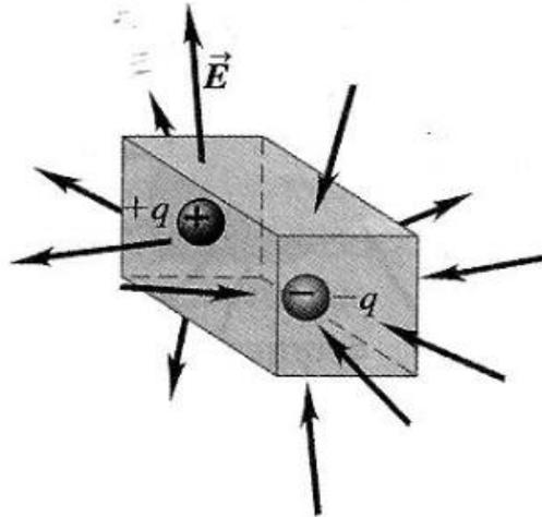
(c) Carga igual a zero dentro da caixa, o fluxo de fora para dentro cancela o fluxo de dentro para fora
