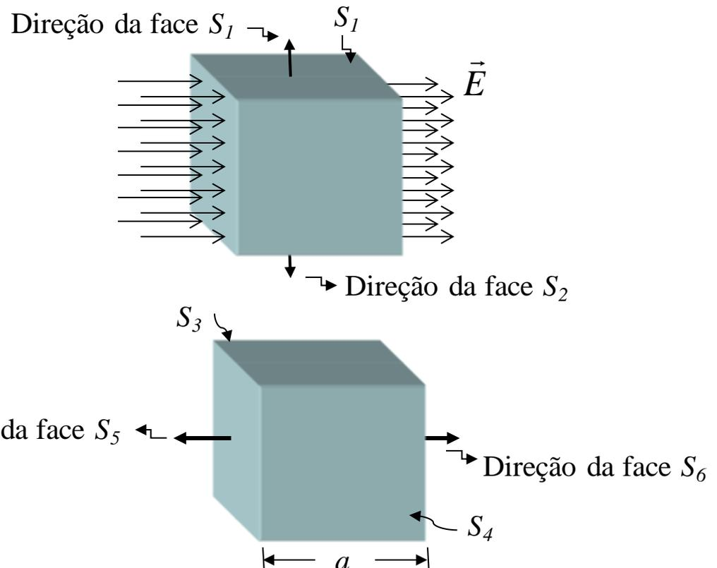
(a) Carga igual a zero dentro da caixa, fluxo igual a zero
