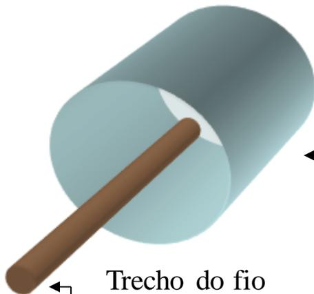
Superfície gaussiana cilíndrica, concêntrica ao fio. (As faces da superfície estão omitidas para melhor visualização.)
