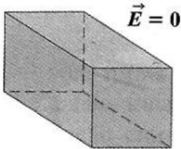
(b) Carga líquida igual a zero dentro da caixa, o fluxo de fora para dentro cancela o fluxo de dentro pra fora
